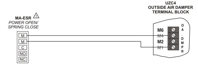
MODEL ND-ESR OR URD-ESR -- POWER OPEN / SPRING CLOSE URD-ESR CAN BE FIELD REVERSED FOR DESIRED OPERATION ND-ESR MUST BE ORDERED AS POWER OPEN / SPRING CLOSE
